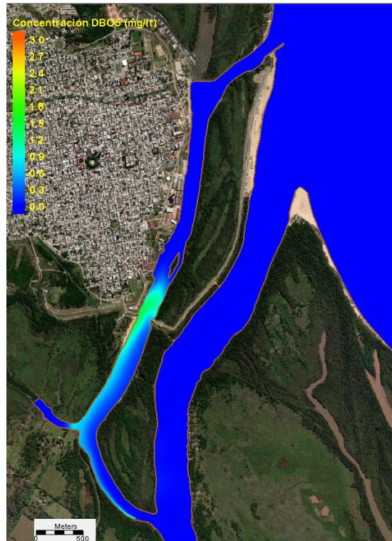
Figura 75 Alternativa 3. Una hora después de la máxima concentración de DBO_5 frente al Balneario Itapé.
