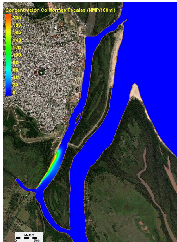
Figura 57 Alternativa 1. Una hora antes de la máxima concentración de bacterias coliformes fecales frente al Balneario Itapé.
