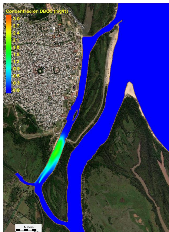
Figura 63 Alternativa 2. Una hora antes de la máxima concentración de DBO 5 frente al Balneario Itapé.
