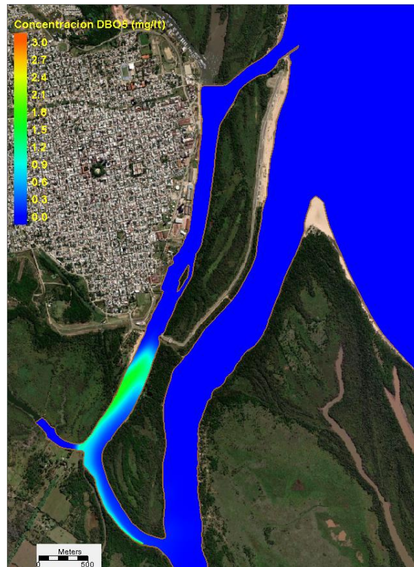
Figura 73 Alternativa 3. Una hora antes de la máxima concentración de DBO 5 frente al Balneario Itapé.
