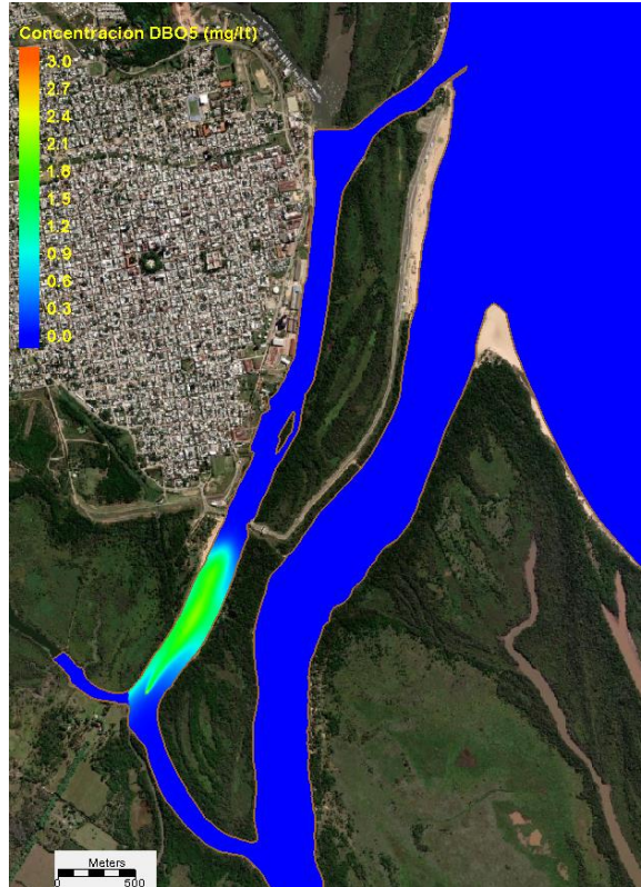
Figura 63 Alternativa 2. Una hora antes de la máxima concentración de DBO 5 frente al Balneario Itapé.
