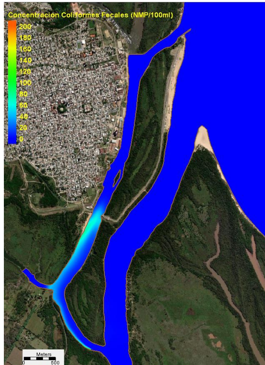
Figura 78 Alternativa 3. Hora de máxima concentración de bacterias coliformes fecales frente al Balneario Itapé.
