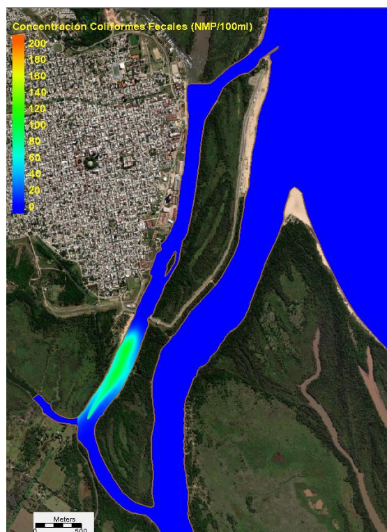
Figura 67 Alternativa 2. Una hora antes de la máxima concentración de bacterias coliformes fecales frente al Balneario Itapé.
