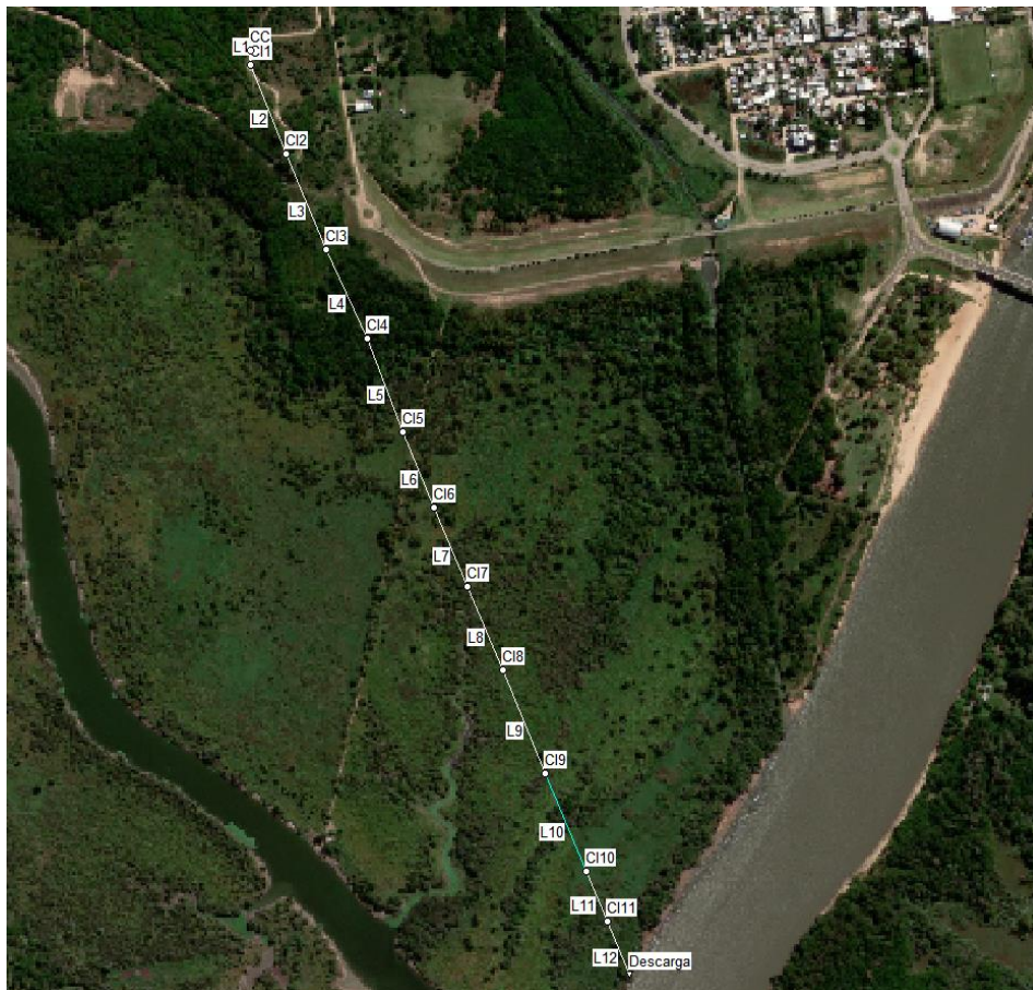
Figura 88 Topología del modelo SWMM.
