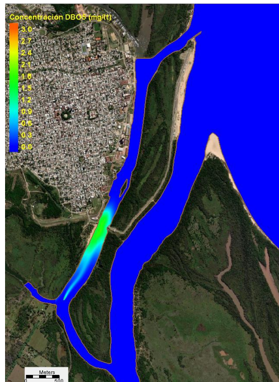
Figura 65 Alternativa 2. Una hora después de la máxima concentración de DBO 5 frente al Balneario Itapé.
