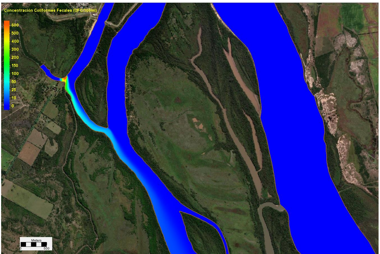
Figura 52 Alternativa 1. Concentración de bacterias coliformes fecales luego de 6 días de descarga constante con caudal de estiaje estacionario.
