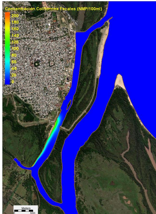
Figura 59 Alternativa 1. Una hora después de la máxima concentración de bacterias coliformes fecales frente al Balneario Itapé.
