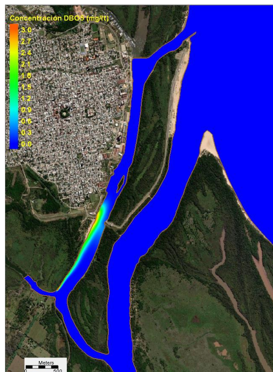
Figura 55 Alternativa 1. Una hora después de la Máxima concentración de DBO 5 frente al Balneario Itapé.
