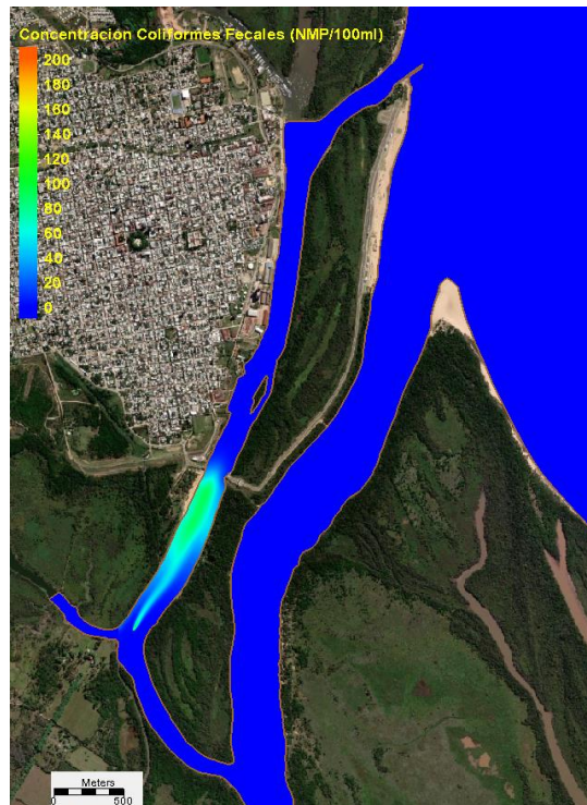
Figura 68 Alternativa 2. Hora de máxima concentración de bacterias coliformes fecales frente al Balneario Itapé.
