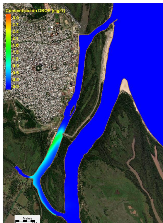
Figura 74 Alternativa 3. Hora de máxima concentración de DBO 5 frente al Balneario Itapé.
