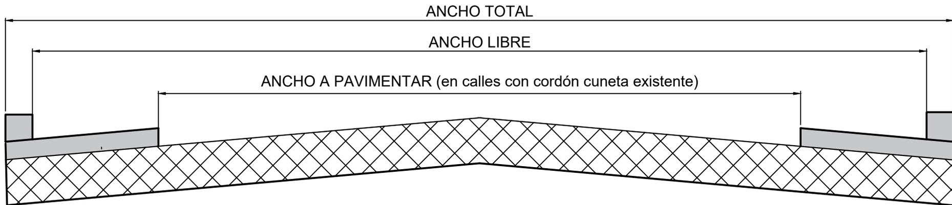
DETALLE PAQUETE ESTRUCTURAL PAVIMENTO
