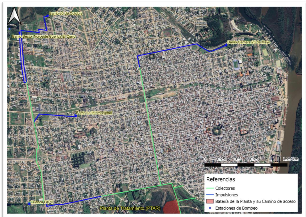
Figura 47 - Ubicación de colectores, estaciones de bombeo y líneas de impulsión. Fuente: Elaboración propia.
