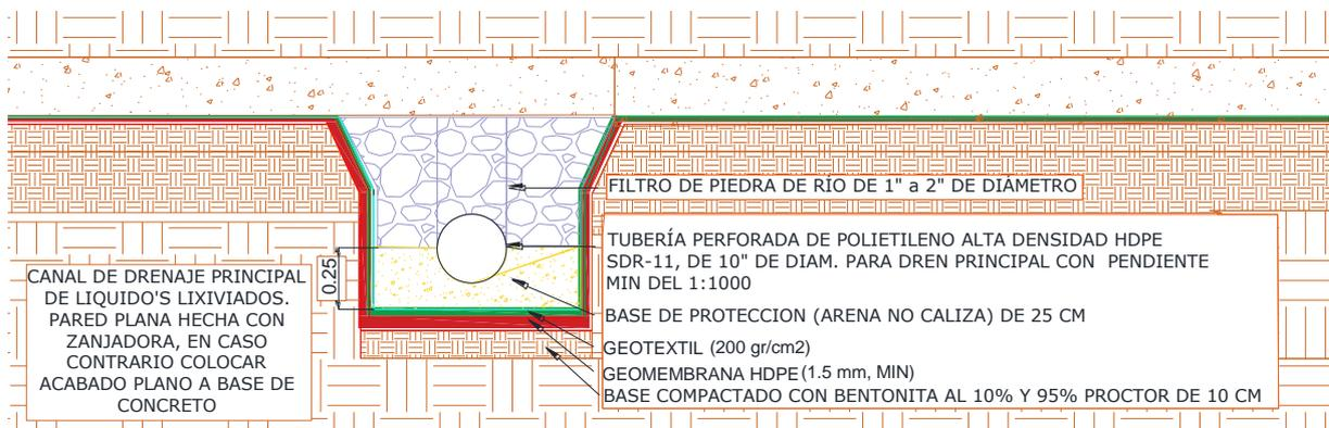
**Figura 18. Detalle instalación de cañerías principal perforada para la captación de los lixiviados.**
