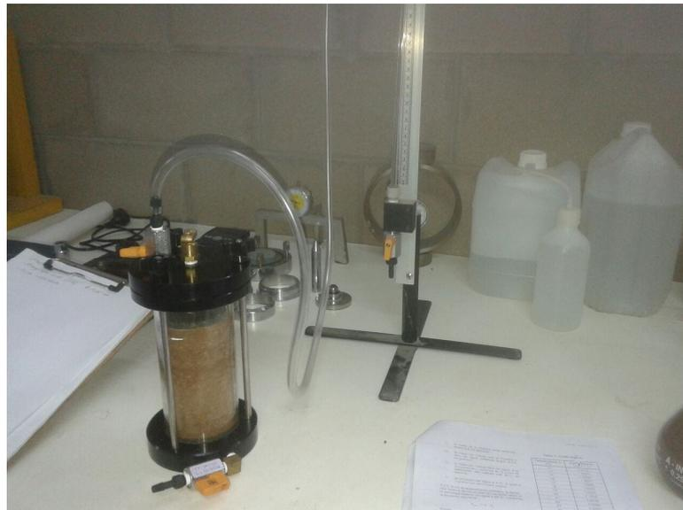
Vista del dispositivo de ensayos de permeabilidad
