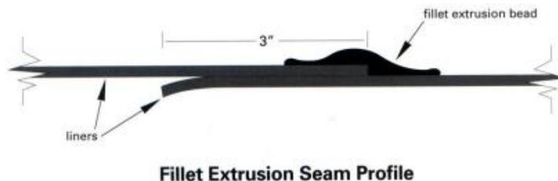
Figura 13. Detalle de soldadura por extrusión.
