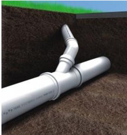
**Figura 19. Detalle instalación de cañerías secundaria ( $\varnothing 160\text{mm}$ ) a caño principal ( $\varnothing 250\text{mm}$ ) ramal simple a  $45^\circ$ .**
